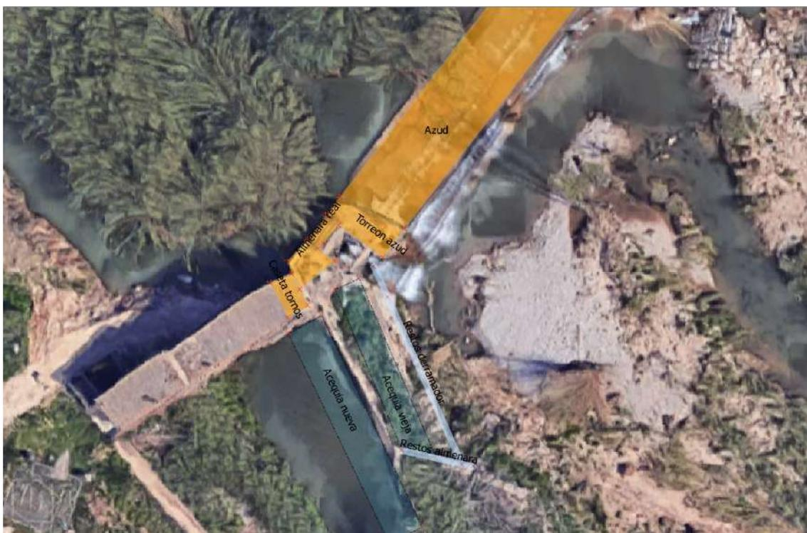
**Fig. 21. Reconstrucción del estado del azud de Quart hacia 1672.**
